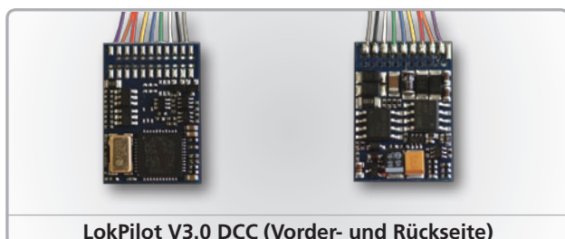
LokPilot V3.0 DCC (Vorder- und Rückseite)
